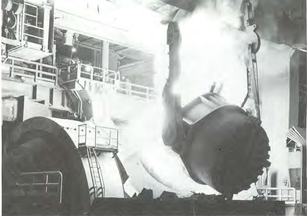
Chargement du four Kaldo à l'usine de Gandrange (Moselle)
